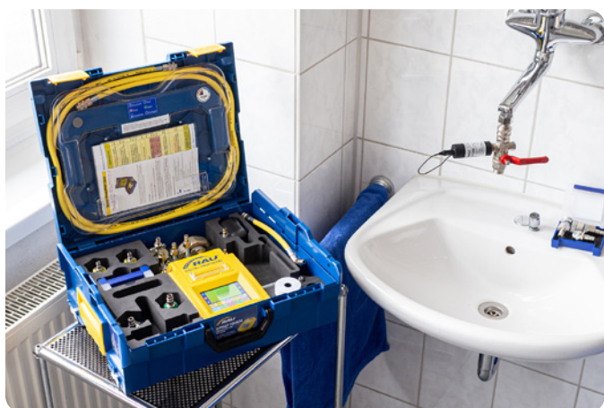
Wasserschlussprüfung mit WPS FUNK + FGP
